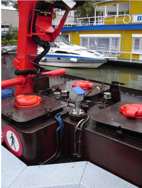
La mesure de niveau TDR d'eau de sentine
