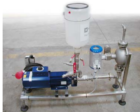
Station de dosage BASF avec OPTIMASS
